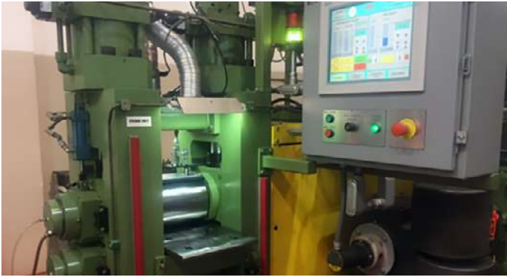
Figura 11. Máquina laminadora de placas y EECC
